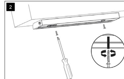
Placer le luminaire à la position désirée et viser le luminaire. Completer le montage en remettant les couverts de plastique sur les trous.
