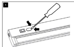
Retirer les couverts de plastique en utilisant un tournevis à tête plate qui recouvre les trous sur le luminaire.
