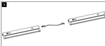
Brancher plusieurs luminaire en les reliant pas le cordon de raccordement.
